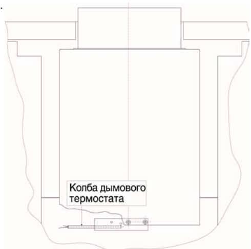
Задний вид котла
