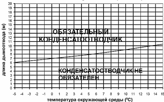
Раздельное дымоудаление (Ø80мм)
